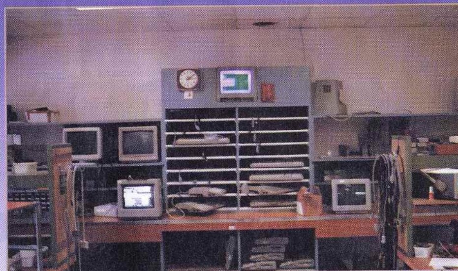
Dans l'atelier technique de GK Services tous les ordinateurs à tester ou réparer tournent au moins douze heures dans le banc de "chauffe" avant diagnostic. La température ambiante est supérieure de dix degrés à celle du reste du bâtiment.
